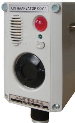
**Предназначен** для выдачи сигнализации о превышении установленных значений массовой концентрации оксида углерода в воздухе.
